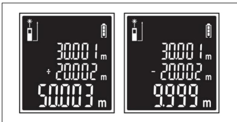
Рис. 6 Прибавление/Вычитание результата из последнего измерения
