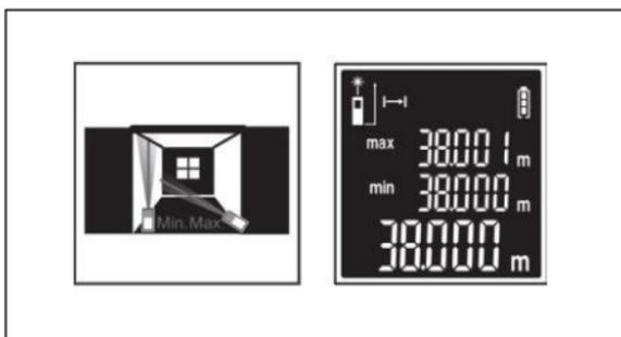
Рис. 4 Режим непрерывного измерения
